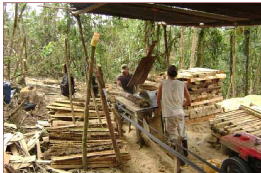
Obtención de tablillas de pigüe o tunash ( Piptocoma discolor ) en aserradero móvil.
